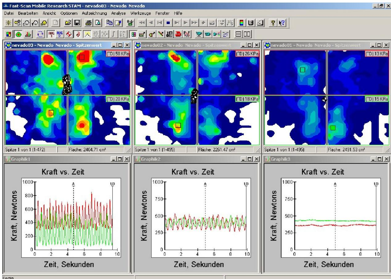
Gegenüberstellung der Druckverteilung von Trab, Schritt und Stand inkl. Kraft-Zeit-Diagramm (erfordert das optionale Research Software Modul) mit der SattelSCAN Software
